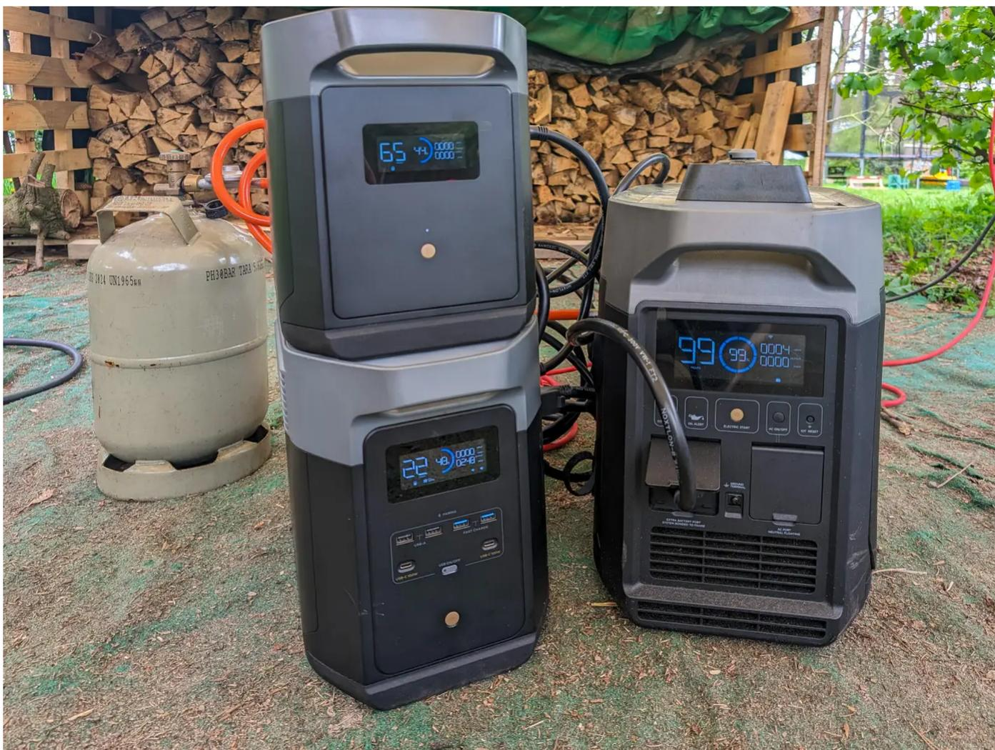
Notstrom Deluxe: Die Geräte von Ecoflow lassen sich kombinieren und per App steuern. Die tragbare Pufferbatterie Delta 2 Max (links unten) mit Speichererweiterung (links oben) speichert 4 kWh. Läuft sie leer, springt der per LPG betriebene Smart Generator automatisch an und lädt nach.
