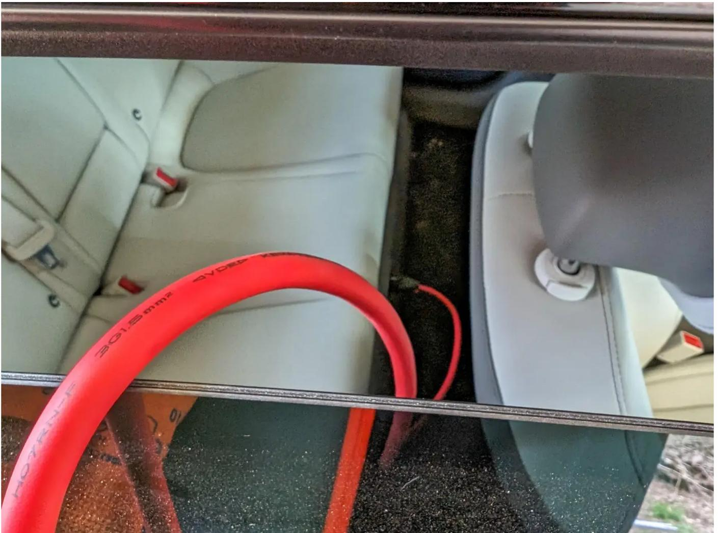
Fenster auf, Zündung an: Im Ioniq 5 ist der V2L-Anschluss unter der Rückbank zu finden.
