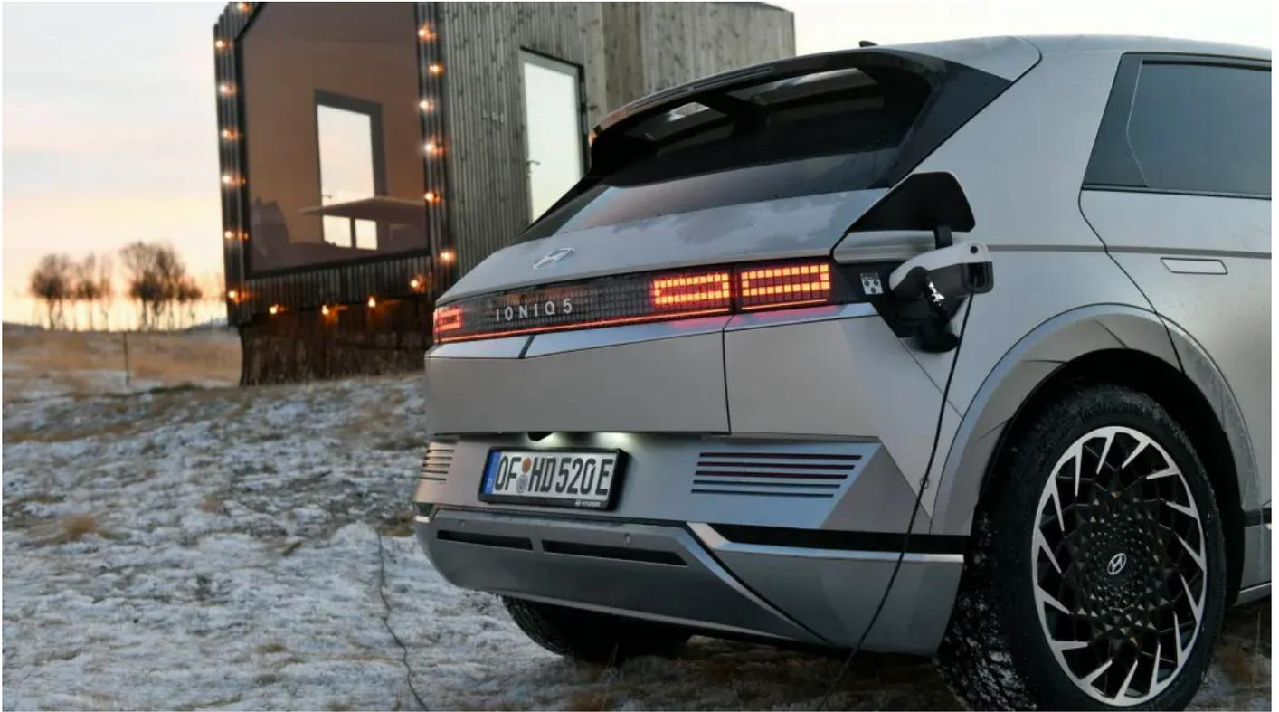
Auch Hyundai arbeitet an V2G (Vehicle-to-grid). Schon jetzt können viele Elektroautos wie dieser Ioniq 5 externe Geräte mit bis zu 3,6 kW Leistung versorgen (V2L = Vehicle-to-Load).
